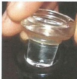
C'est un cylindre de verre qui assure un bouchage complètement hermétique, cette méthode étant souvent utilisée en chimie. Un anneau d'étanchéité en plastique permet le maintien du bouchon et l'étanchéité.
